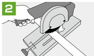
2 高速カッターを用いて、手すり本体を必要な長さに直角に切断してください。切断時に生じたバリは、ヤスリなどを用いてきれいに取り除いてください。
