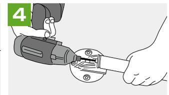
4 切断した手すり本体とインサートナットを皿タッピンねじでしっかりと固定してください。次にインサートナットとブラケットベースをインサートボルトでしっかりと固定してください。
