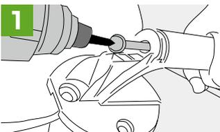
1 インサートボルトをはずし、手すり本体とブラケットベースをはずしてください。さらに、皿タッピンねじをはずし、手すり本体とインサートナットをはずしてください。
