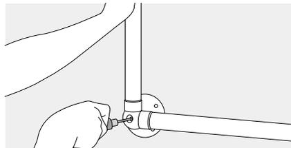
縦手すりの取付位置を決め、ブラケットベースにある剥離紙を剥がし、両面テープがしっかり付くようにブラケットベースを均等にしっかりと押し付けてください。その後ボルトの本締めを行ってください。
