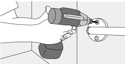
プラスドライバーまたは電動ドライバーでゆっくりとトラスタッピンねじを締め付けてください。
