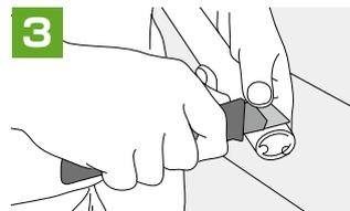
3 切断した手すり本体の端部のグリップ部分をカッターナイフで削ってください。(手すり本体の両端約4mmのグリップ部分を上図のように削ってください。)
